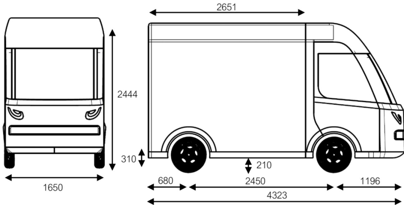
Son châssis original en sandwich alu lui permet d'avoir un **seuil de chargement** bas et une zone de chargement plane. L'espace suffisant entre les passages de roues permet d'y placer une palette de type EURO. L'E-truck est optimisé pour le chargement et déchargement facile des marchandises.
